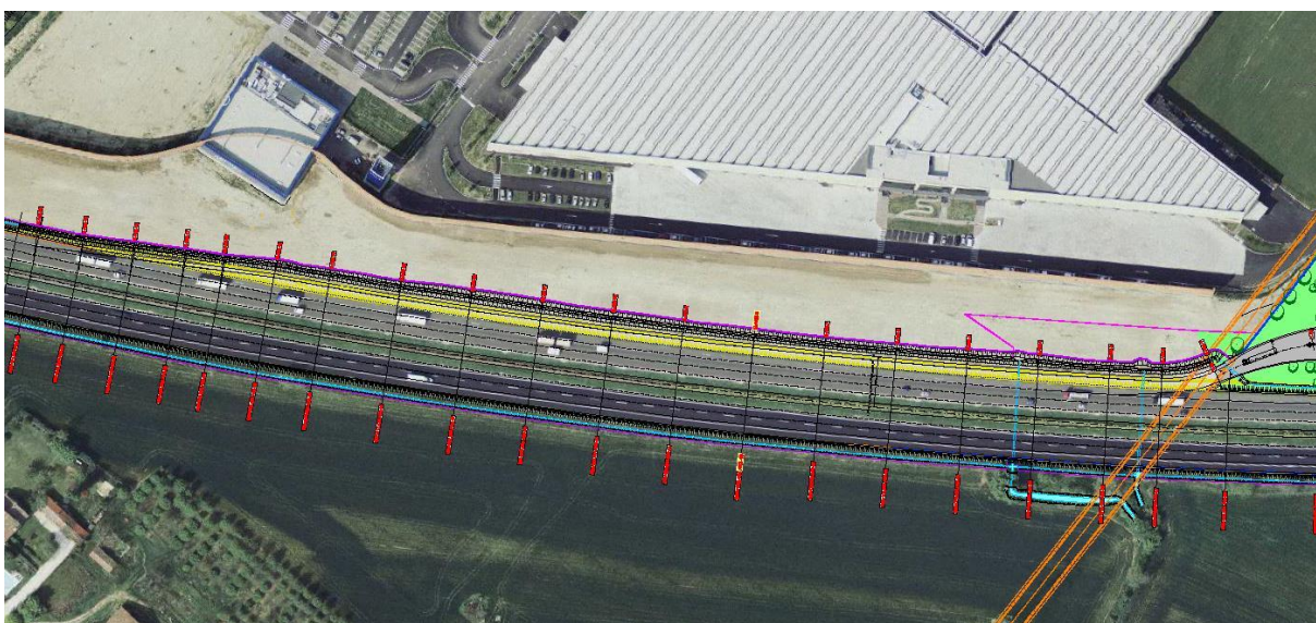
Figura 6-Dettaglio corsia di accelerazione
