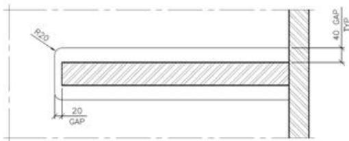
Figura 5-5 Attuale dettaglio di diaframma trasversale a livello dell'irrigidimento longitudinale
