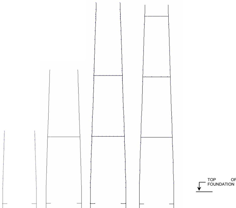
*Figura 4-1 Modelli di analisi per le fasi critiche di costruzione e per la torre completata*
