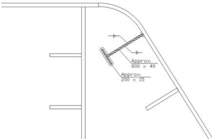
*Figura 7-1 Irrigidimento longitudinale modificato utilizzando un pezzo a T*
