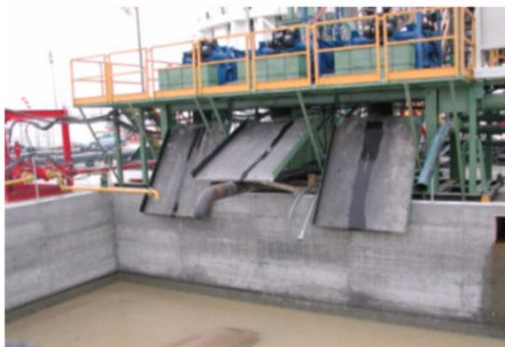
**Figura 4.1.2.b – Scarto e raccolta detriti fanghi di perforazione**
