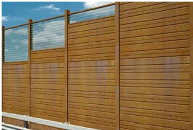
Figura 54 – Stralcio rendering barriera Acciaio-PMMA
