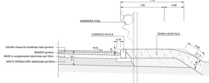
SEZIONE TIPO RAMPA BIDIREZIONALE SU CV06 (CAVALCAVIA AUTOSTRADA A26)
