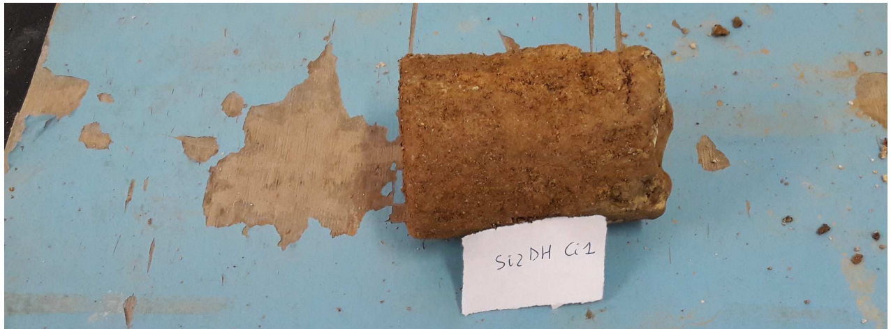
Foto 37: Campione indisturbato Si2DH_Ci2 da m 11.40 a m 12.00 dopo esecuzione delle prove di geotecniche
