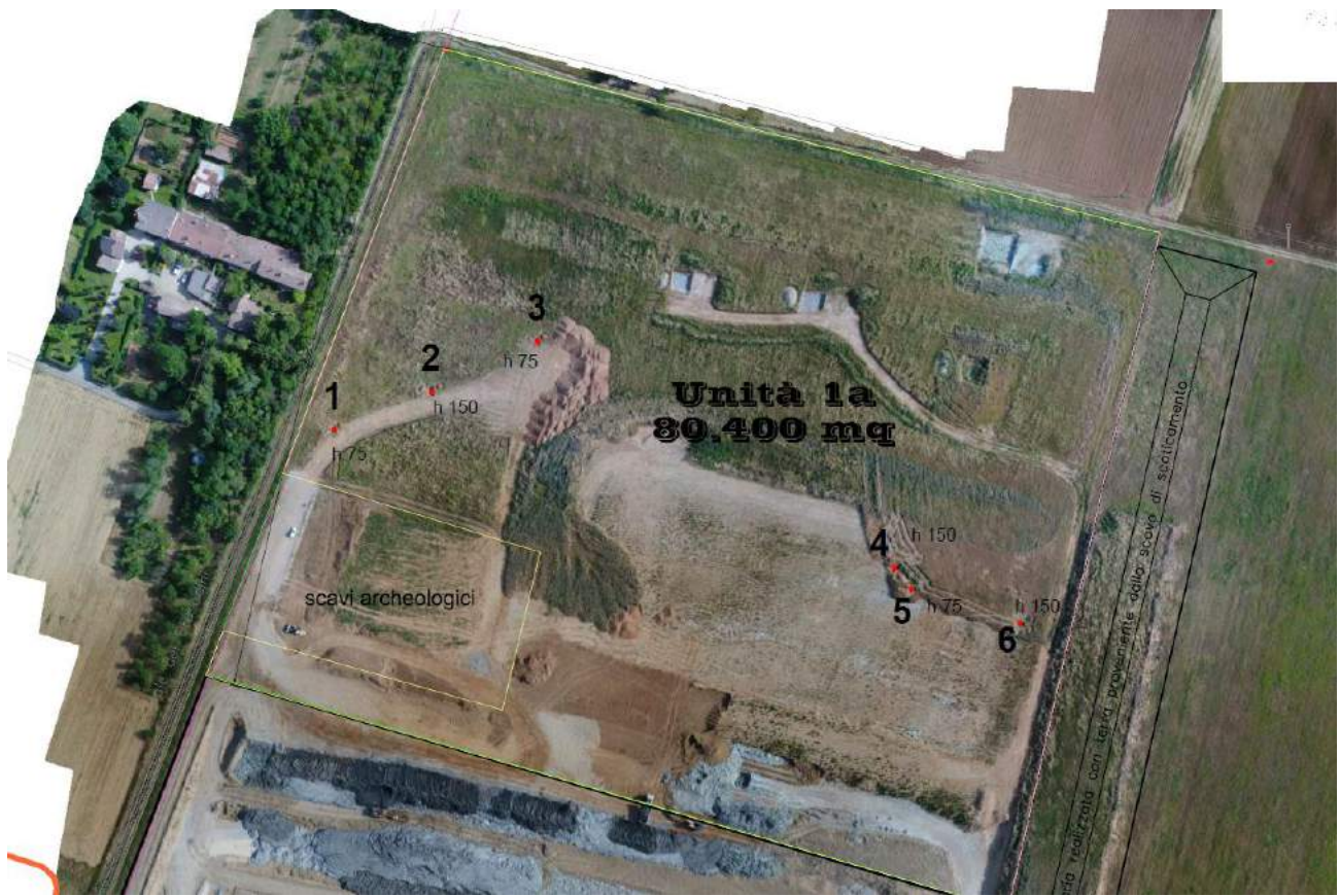
Figura 4 - Ubicazione di 6 degli 8 punti in cui sono state effettuate le prove infiltrometriche.
