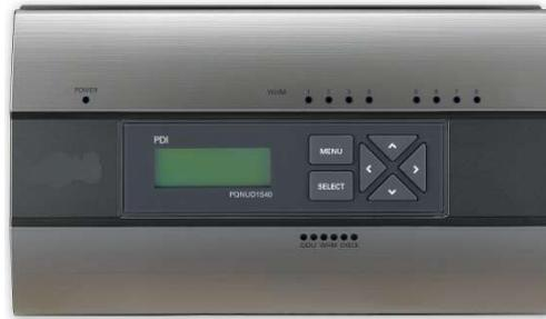
Unità di contabilizzazione dei consumi energetici. In abbinamento ad un wattmetro digitale con uscita ad impulsi, l'unità esamina l'utilizzo delle singole unità interne collegate al sistema MULTI V e ripartisce su di esse il consumo totale dell'impianto.
