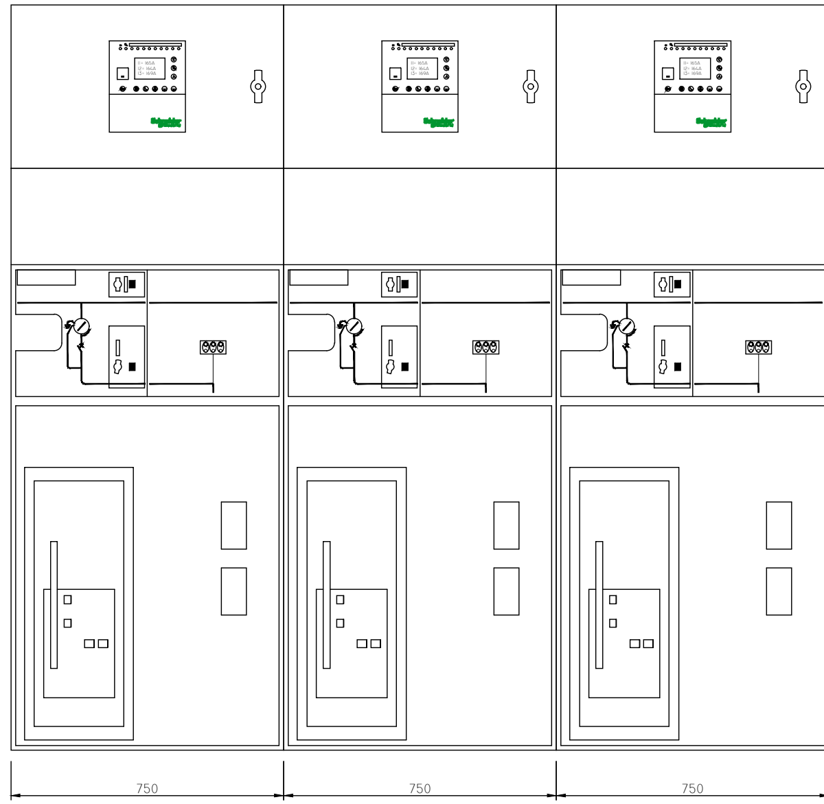
QMT-03 FRONTE QUADRO MEDIA TENSIONE SAN TEOFANIO
