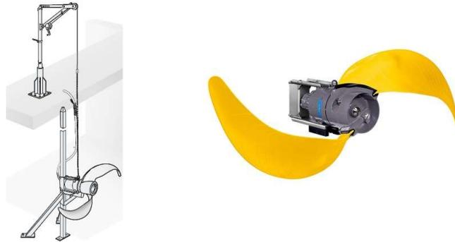
La spinta di reazione di tali miscelatori è in grado di movimentare 1330 l/s con una velocità di rotazione di 47 giri/min. I miscelatori sono orientabili al fine di consentire il corretto indirizzamento della corrente. I miscelatori saranno posizionati ad una profondità di 2,5 m rispetto all'asse delle pale, così da non creare turbolenze superficiali.
