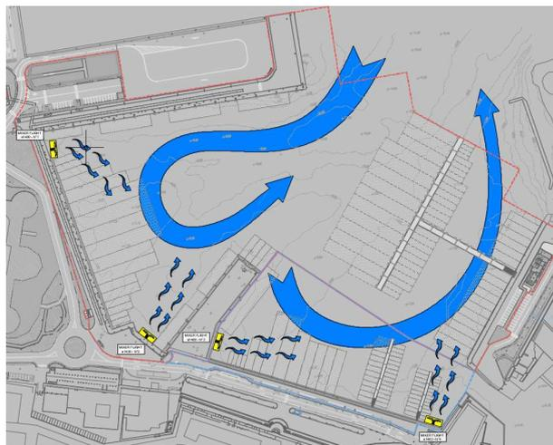
Complessivamente sono previsti 4 mixer: uno all'incrocio tra le banchine 6 e 7 (nelle successive fasi di progettazione si dovrà verificare la posizione in funzione degli ormeggi di banchina 7); uno all'incrocio con le banchine 5 e 4, uno all'incrocio delle banchine 4 e 3 ed uno all'estremità opposta della banchina 3.
