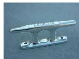
Galloccia da 5t in lega di alluminio bonificato per l'ormeggio dei natanti con lunghezza fino a 12m, completa di bulloneria inox per fissaggio.
