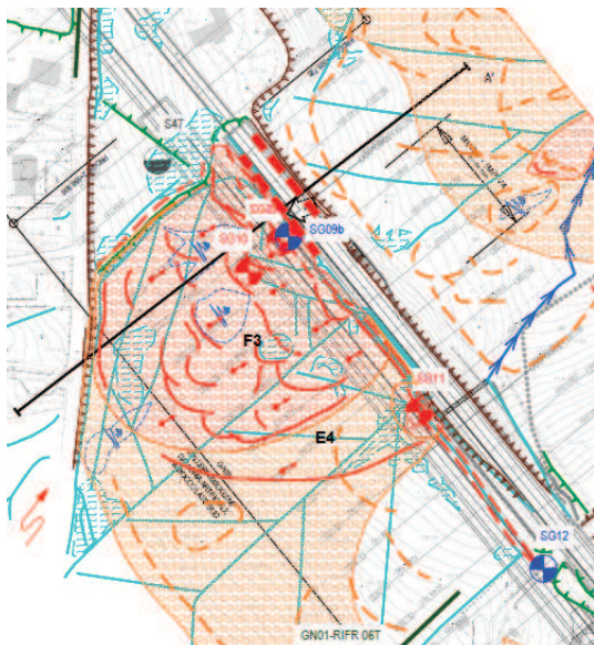
Parziale riattivazione E4: Galleria Barcaglione. Imbocco lato- dissesti km 3+110-3+275 lato monte
