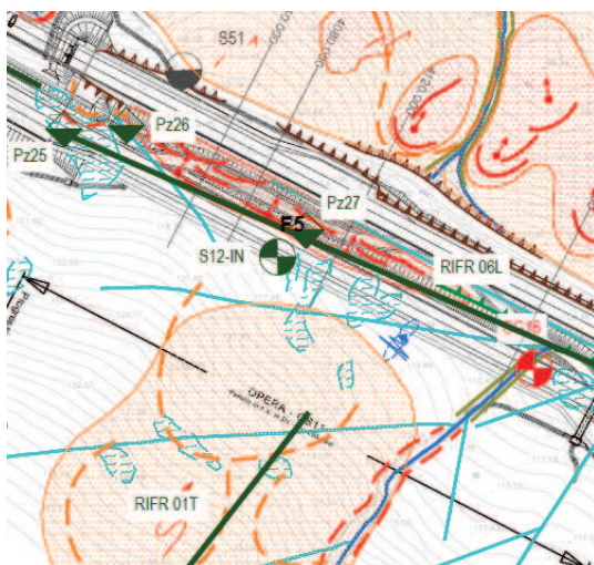
Dissesto tra Rilevato e Galleria Orciani - km 3+980 – 4+240 lato valle
