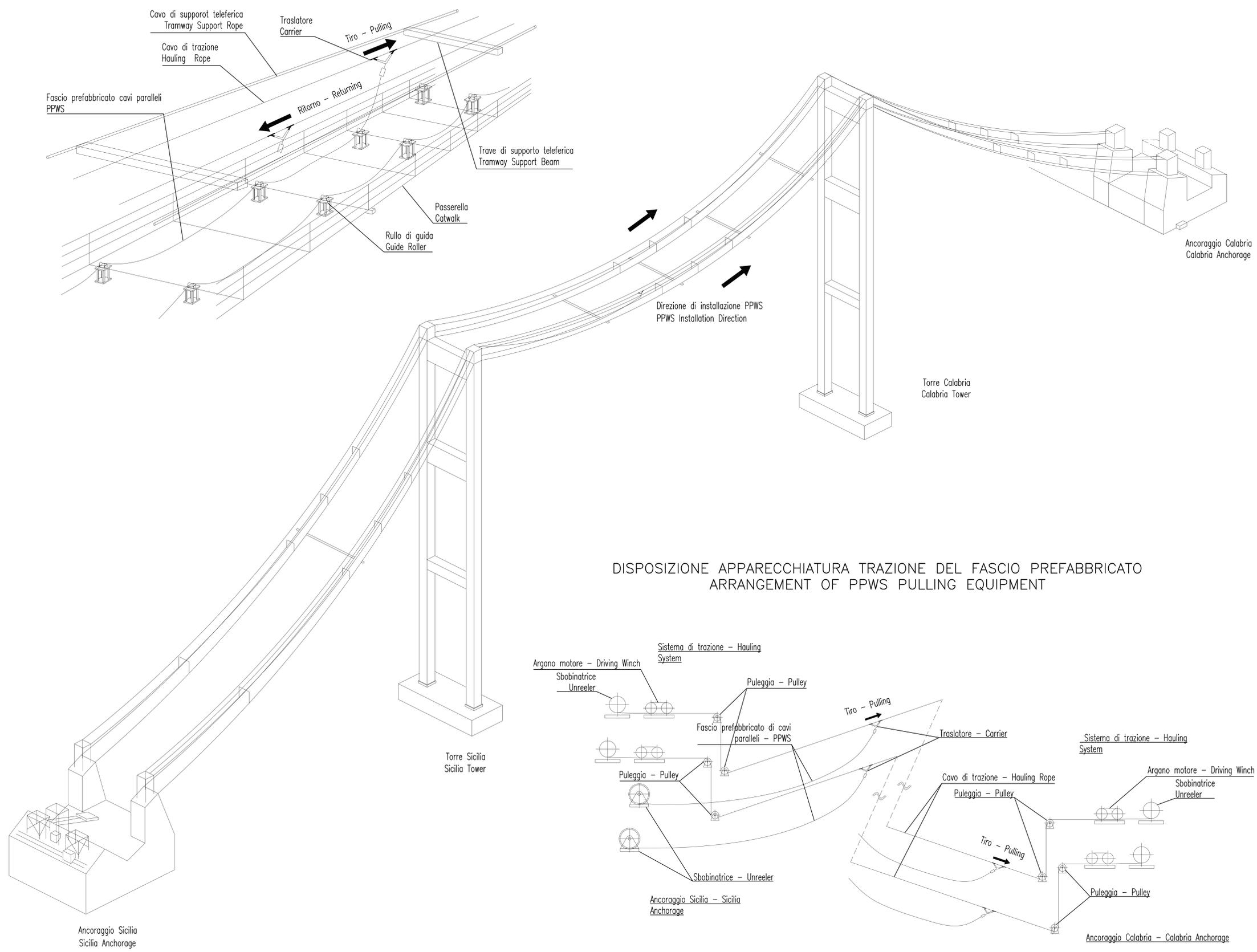
DISPOSIZIONE APPARECCHIATURA TRAZIONE DEL FASCIO PREFABBRICATO
