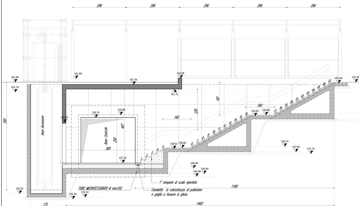
PARTICOLARE COSTRUTTIVO SOTTOPASSO
