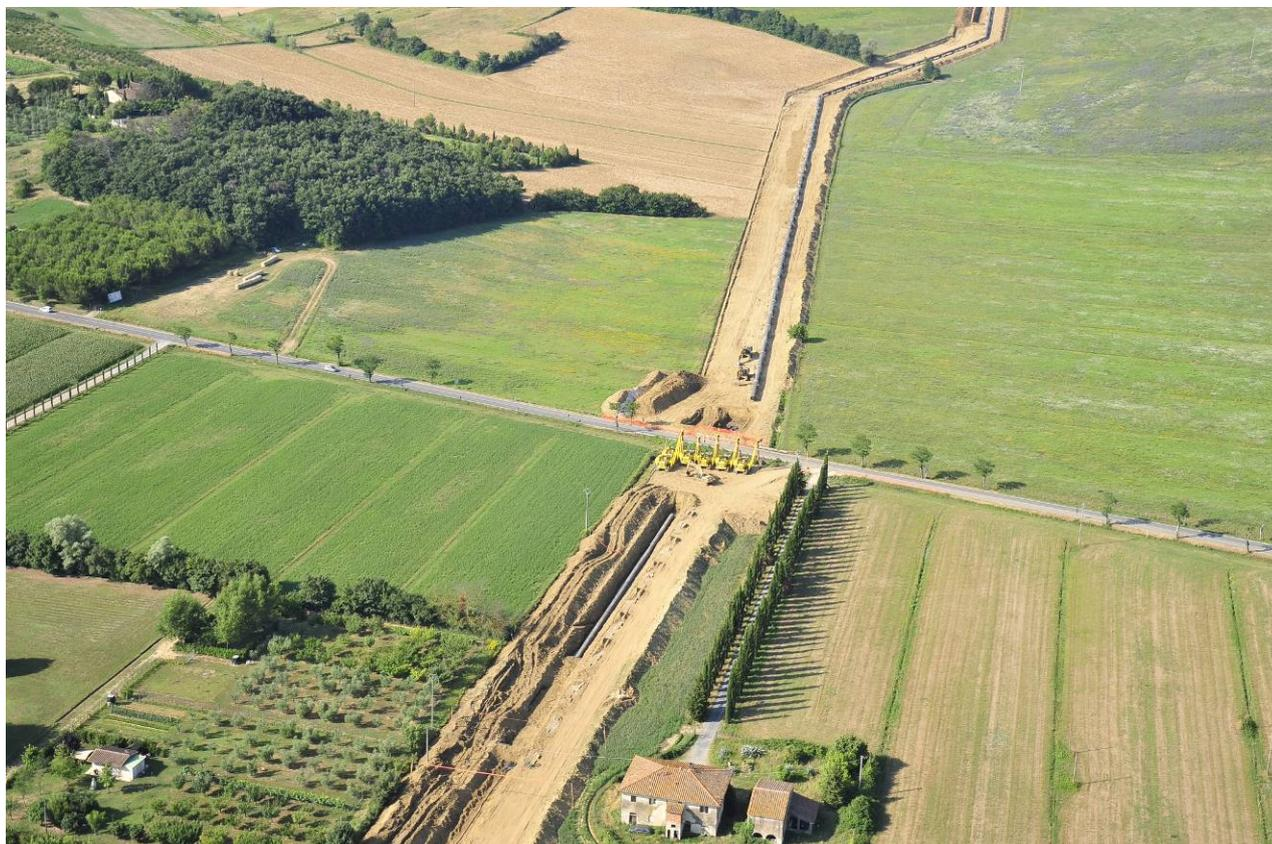
**Fig. 9.5 - Panoramica dell'area di un tratto di metanodotto soggetto a T.O.C. per l'attraversamento di un'infrastruttura viaria.**
