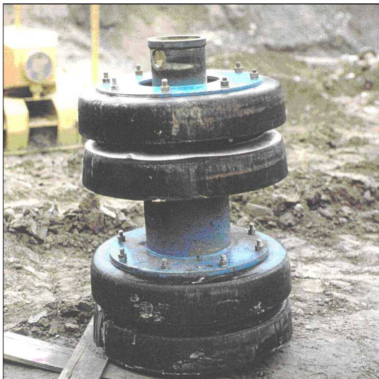
Fig. 3.16 - Pig convenzionale impiegato nelle operazioni di collaudo idraulico e di pulizia della condotta.
