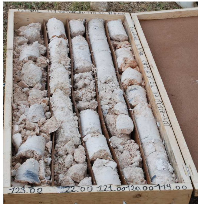
Figura 2.5.41 - Aspetto del calcare vacuolare, nel sondaggio S 450.
