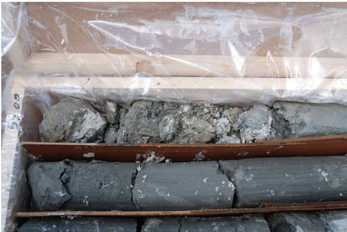
Figura 2.5.20 – Sondaggio S 452: particolare della argille gessose in cui prevale il gesso.
