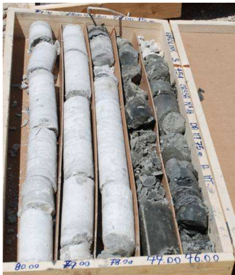
Figura 2.5.22 - Livello gessarenitico con passaggio ad argille gessose nel sondaggio S 451.
