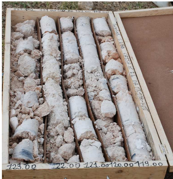
Figura 2.5.23 - Aspetto del calcarea vacuolare, nel sondaggio S 450.
