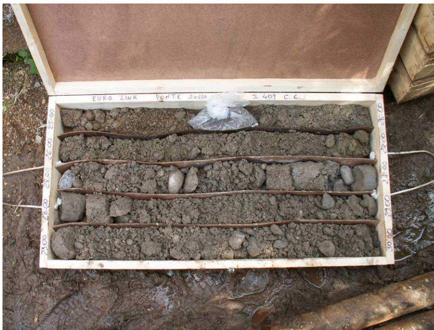
Figura 2.5.38 - Formazione delle Ghiaie e sabbie di Messina. Livello prevalentemente a ghiaia grossolana (sondaggio S 409).
