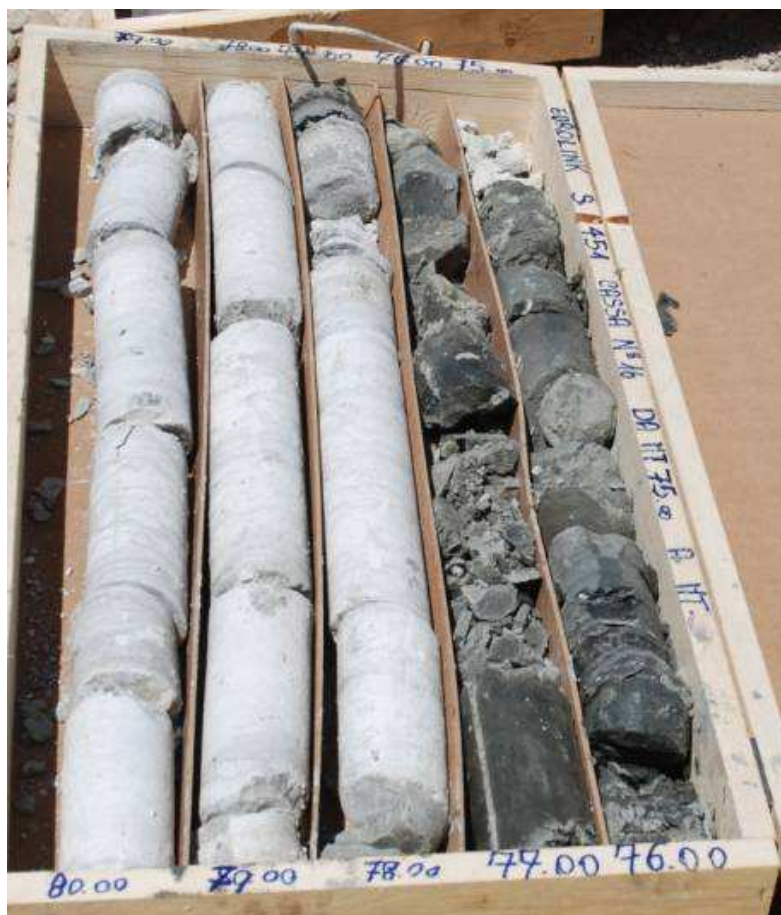
Figura 16 - Livello gessarenitico con passaggio ad argille gessose nel sondaggio S 451.
