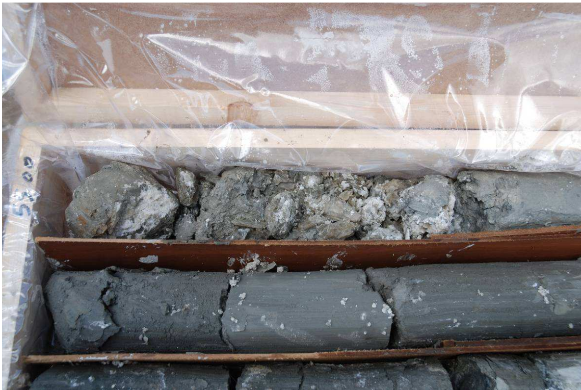
Figura 14 – Sondaggio S 452: particolare della argille gessose in cui prevale il gesso.
