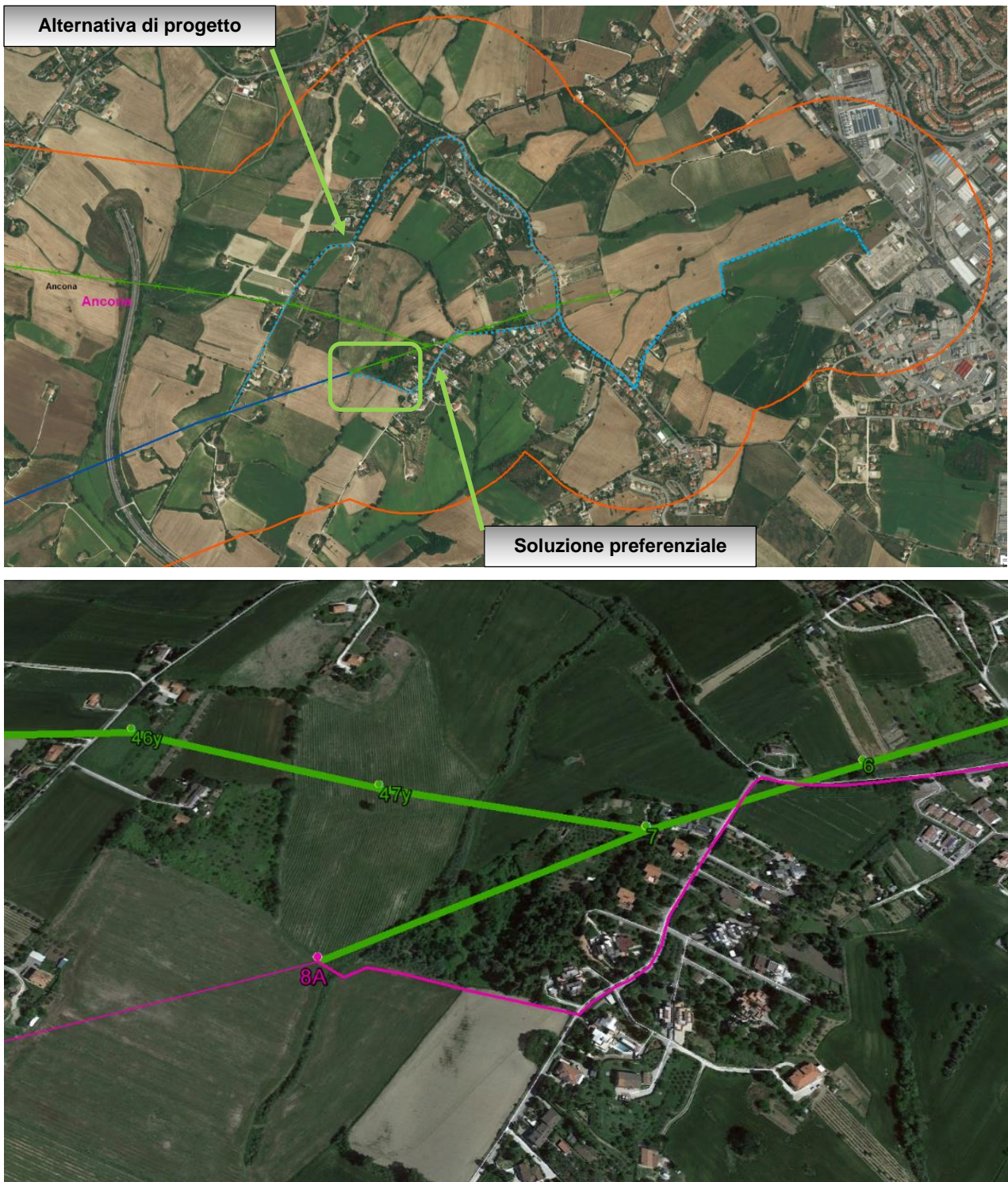
Figura 14 – Tracciato preferenziale e alternativa in cavo interrato SE Candia- PPT 8A; dettaglio del tracciato in cavo nel tratto di connessione con la linea aerea esistente in viola (in verde linee oggetto di demolizione)
