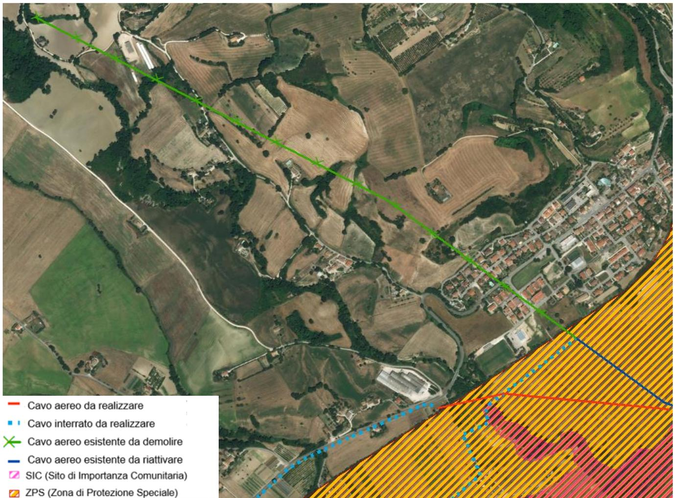
**Figura 8-7 Interventi di demolizione della linea aerea esistente**
