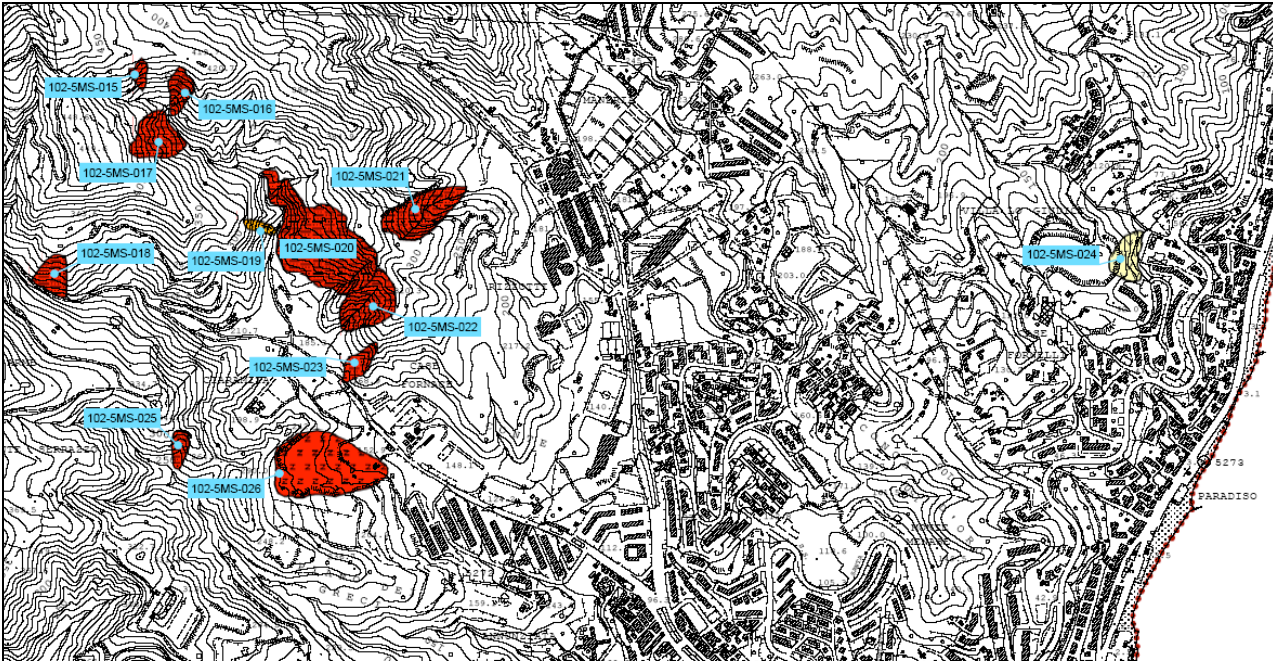
Fig. 15: Stralcio 2 della Tavola 588150_04 della Carta dei dissesti allegata al P.A.I. Sicilia, in scala originale 1:10.000.
