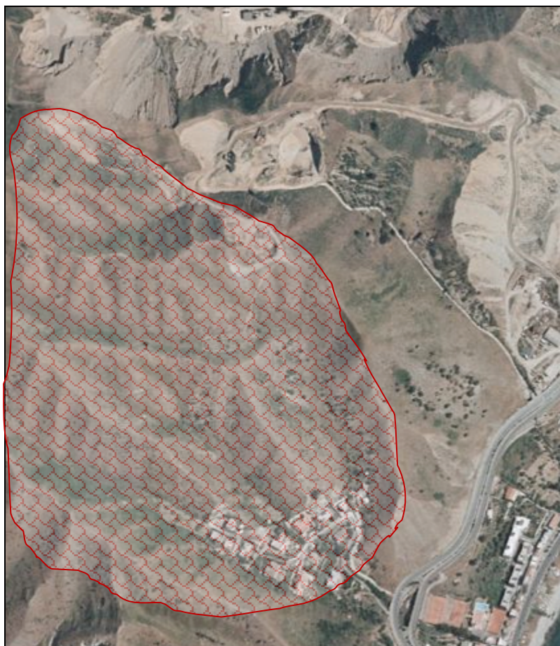
Fig. 7. Con la campitura è evidenziata una zona soggetta a diffusi processi erosivi di tipo rill e gully erosion .
