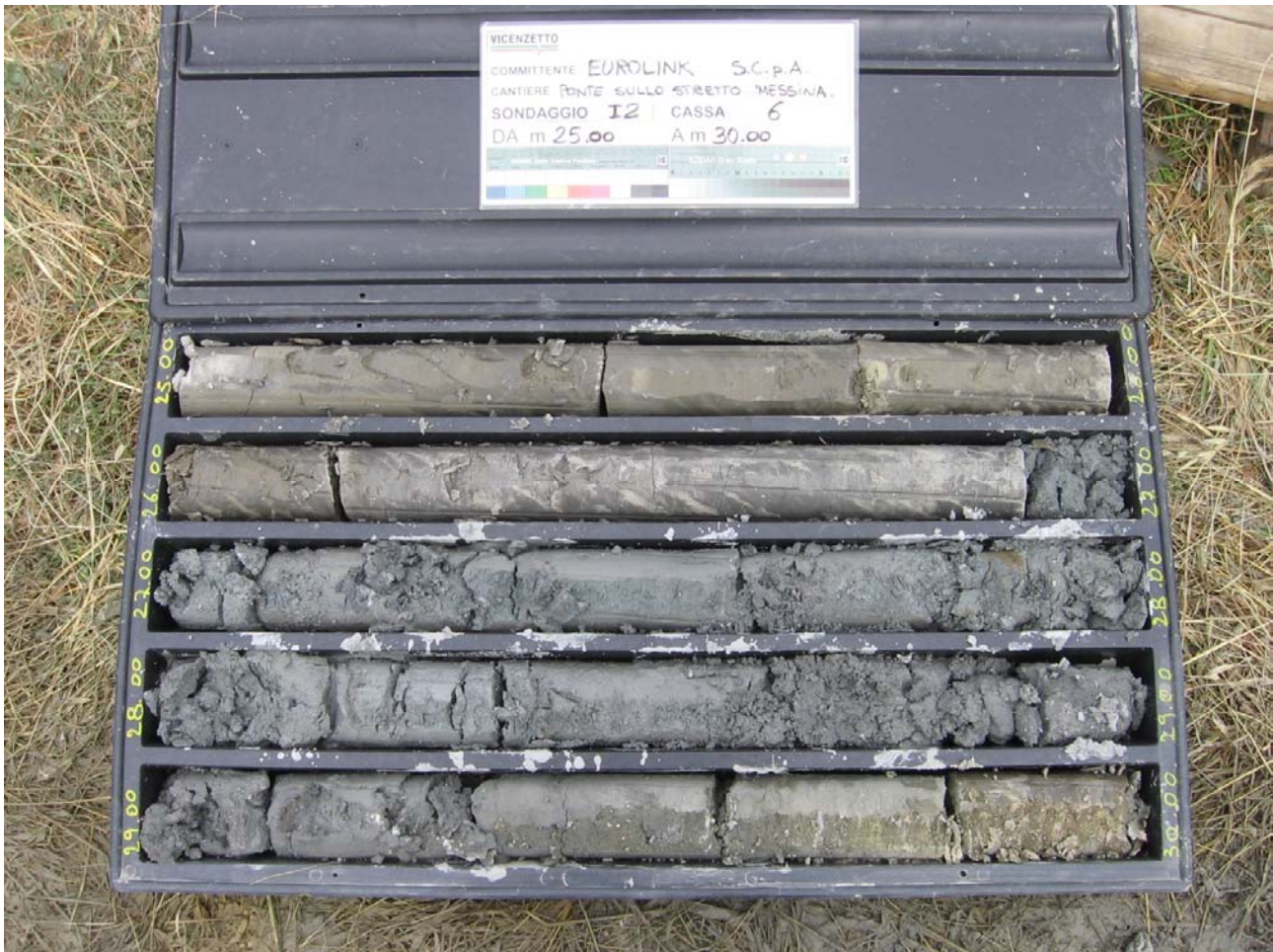
Fig. 14 – Foto della cassetta 6 relativa la sondaggio I2 nella quale si osserva (a circa 27 m dal p.c.) il passaggio dalle argille ai conglomerati della Formazione di San Pier Niceto.
