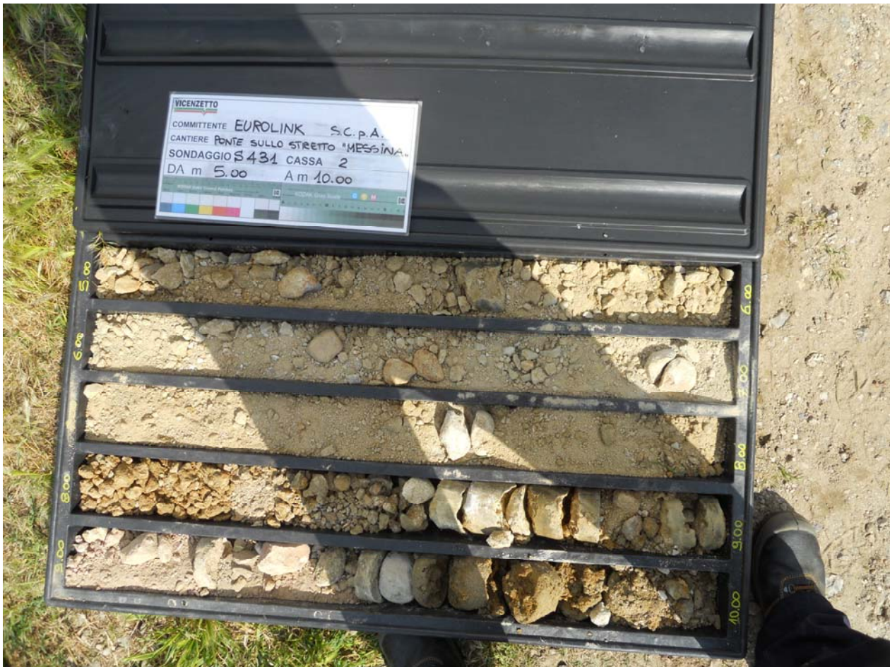
Fig. 12 – Foto della cassetta 2 relativa la sondaggio S431 nella quale si osserva (a circa 8.7 m dal p.c.) il passaggio dal detrito di frana ai conglomerati della Formazione di San Pier Niceto.
