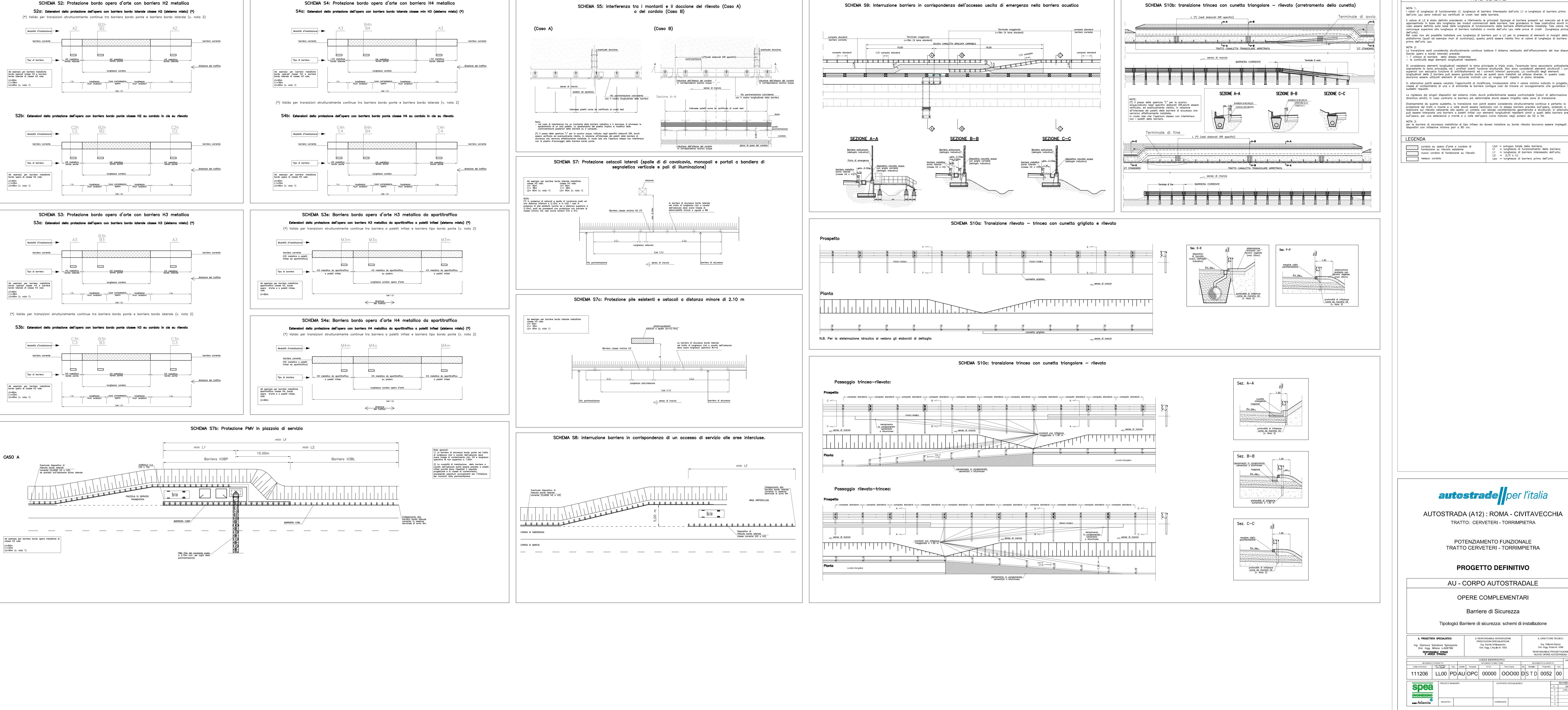
SCHEMA S4: Protezione bordo opera d'arte con barriera H4 metallica
