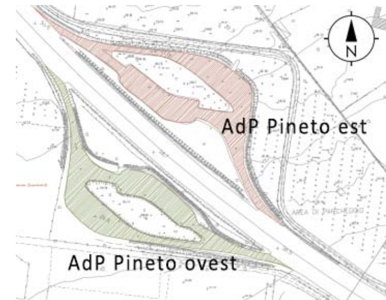
Figura 2-37: aree di cantiere presso le aree di parcheggio Pineto Est e Ovest – in verde l'area di cantiere base in corrispondenza del parcheggio "Il Pineto Ovest", in marrone l'area di occupazione temporanea (eventuale) presso il parcheggio "Il Pineto Est"
