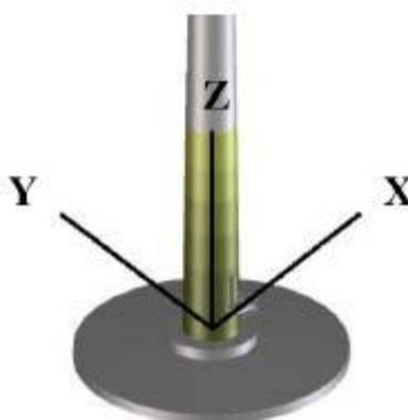
Figura 1. Definizione del sistema di coordinate secondo IEC 61400-1
