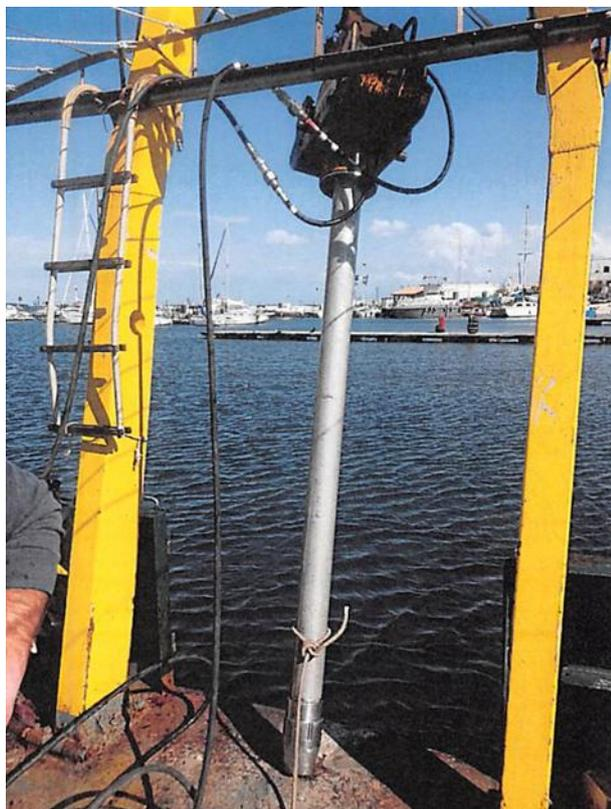
**Figura 3** – Carotiere vibroinfissore
