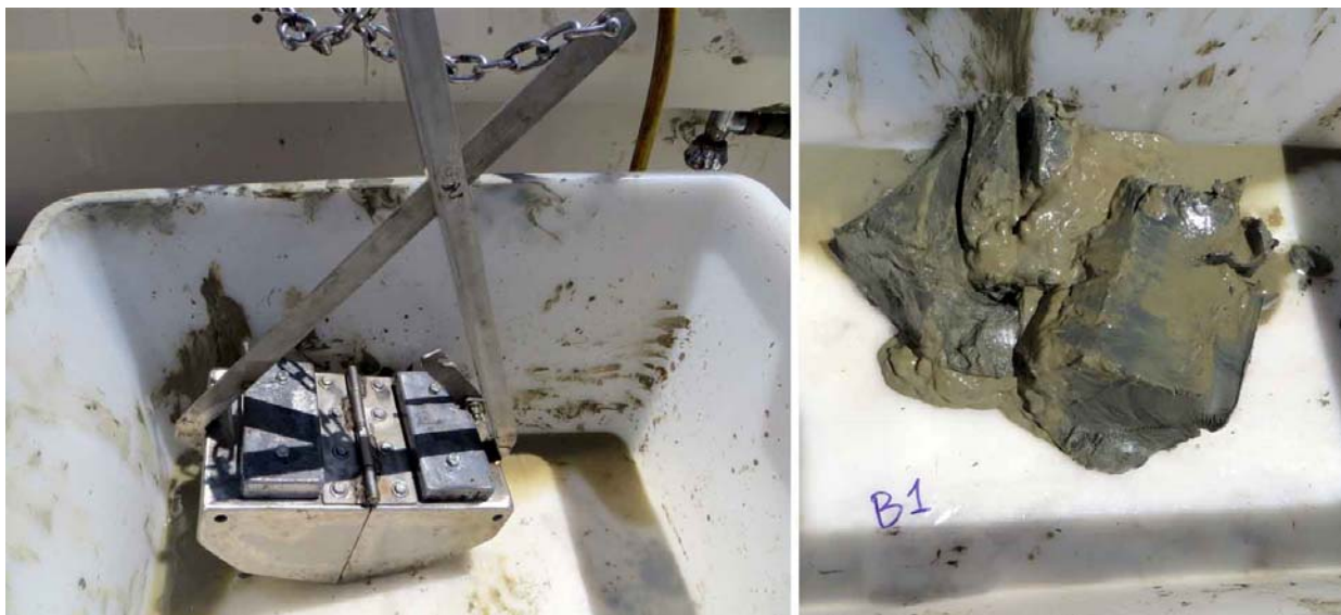
Fig 21. Benna Van Veen utilizzata per i campionamenti di sedimento (a sinistra) ed esempio di campione raccolto (a destra).
