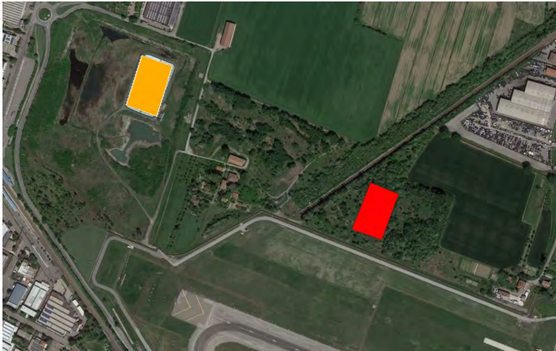
Fig. 5 Localizzazione della nuova vasca di laminazione in progetto (in giallo la vasca attuale interna il sito di ex cava Olmi, in rosso la nuova vasca prevista a nord del sedime aeroportuale)
