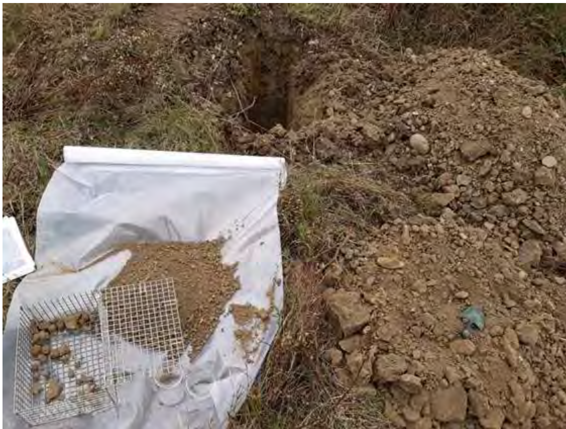
Fig. 36 Fasi di miscelazione, vagliatura e di quartatura del materiale prelevato da ogni punto di scavo in sezione.
