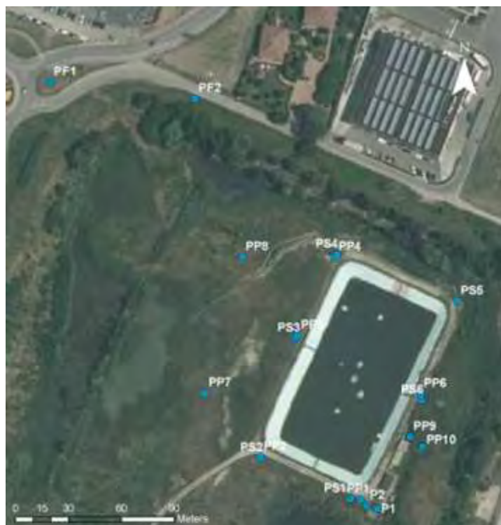
Fig. 8 Ubicazione dei piezometri di monitoraggio (2013 e 2015) per lo Studio Idrogeologico dell'area di Cava Olmi – Dipartimento di Scienze Chimiche e Geologiche UNIMORE Bologna)
