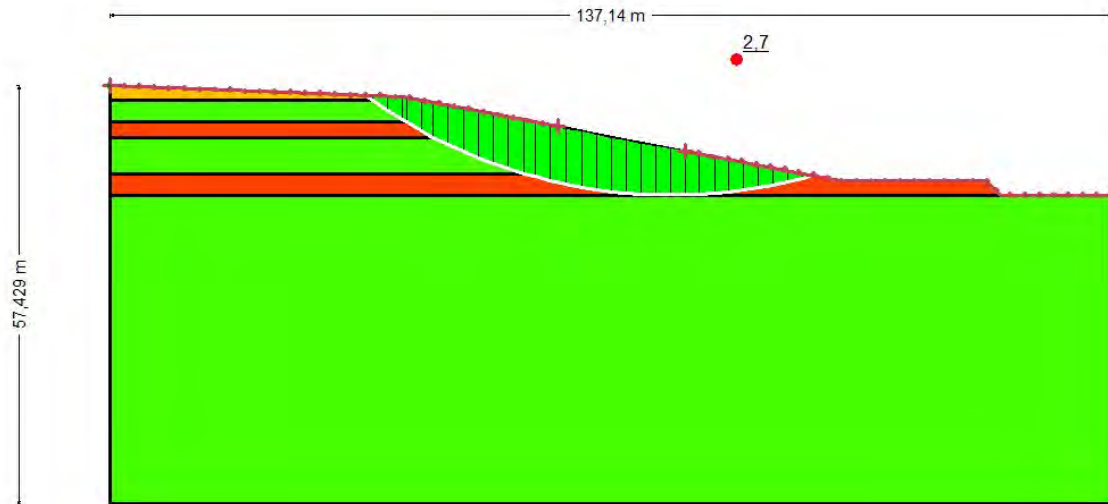
Fig. 40 Stato attuale - Output grafico di analisi di STABILITA' con indicazione della superficie critica e F_s risultante (per la legenda si veda in calce alla figura 41)
