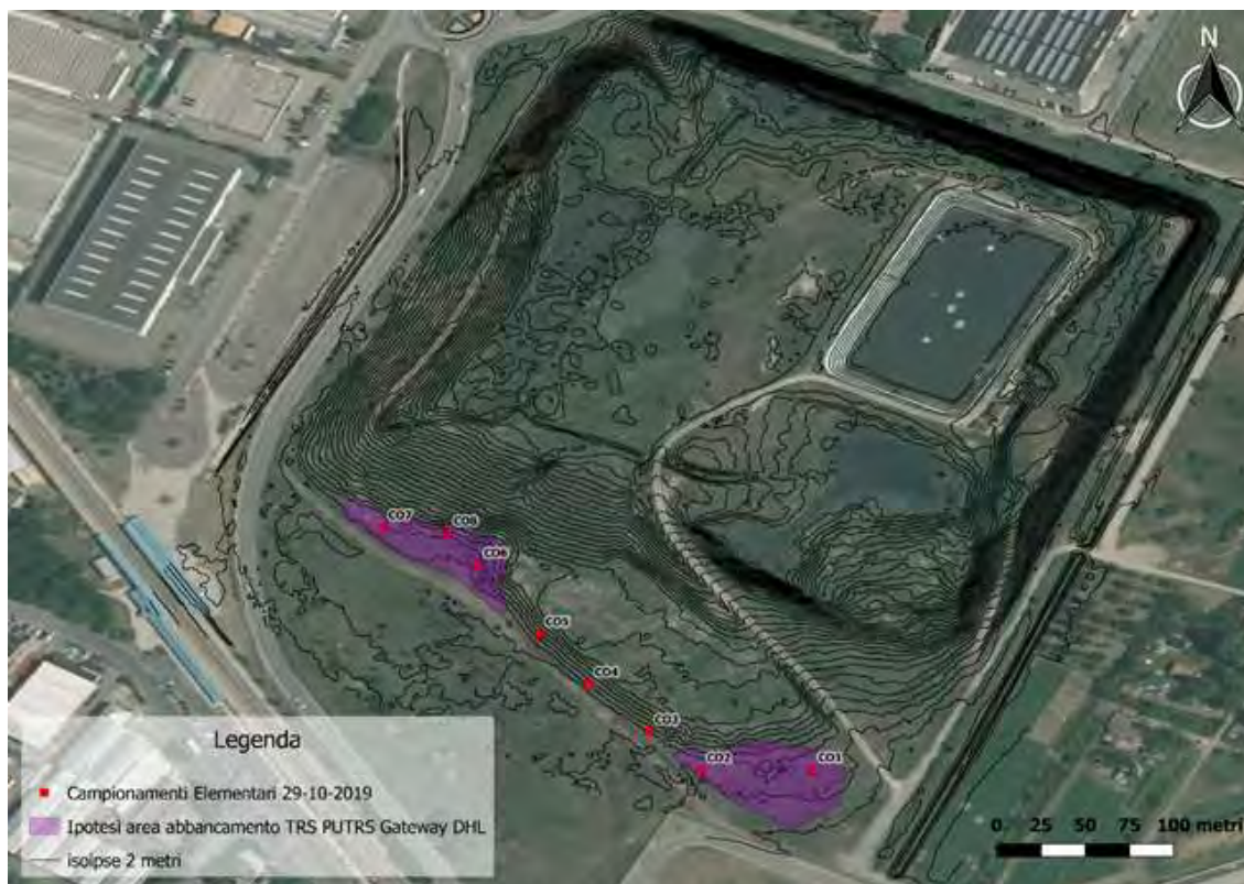
Fig. 33 Ubicazione dei Campionamenti Elementari all'interno dell'area ipotizzata per l'abbancamento dei materiali TRS derivanti dal sito Gateway DHL. Rappresentazione alla scala della cava su base ortofoto.
