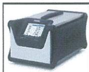
L'analizzatore include i seguenti detector: NDIR (pneumatico) per la determinazione del CO e CO<sub>2</sub>, chemiluminescenza e fornello catalizzatore per la determinazione di NO<sub>2</sub>, sensore paramagnetico per le misure di O<sub>2</sub>.
