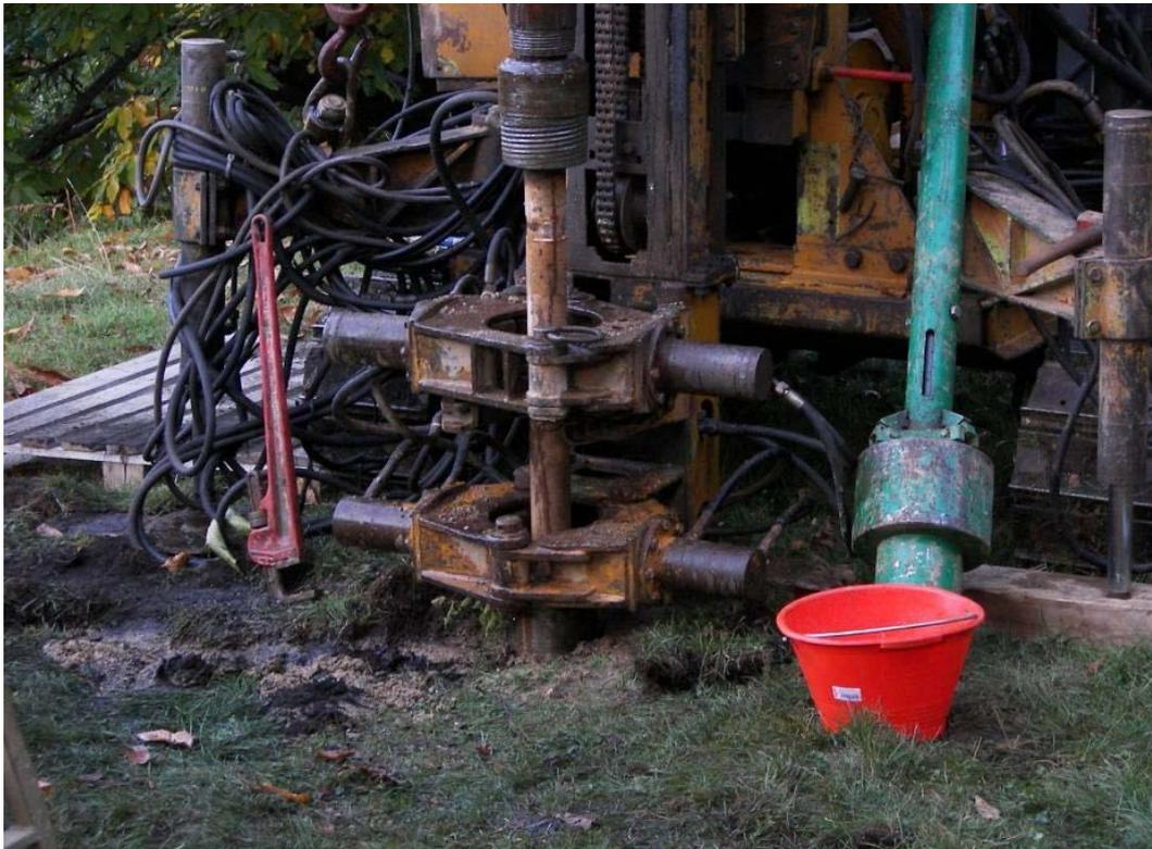
**Figura 3.3-15 Macchina operatrice per la realizzazione di micropali tubfix; sistema di scavo a rotopercussione**
