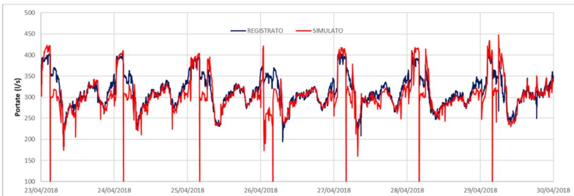
Figura 23 - Andamento delle portate nella condotta di adduzione principale al punto di consegna del comprensorio di ETRA a Battaglia Terme a confronto tra quello simulato dal modello (in rosso) e registrato dal telecontrollo (in blu).
