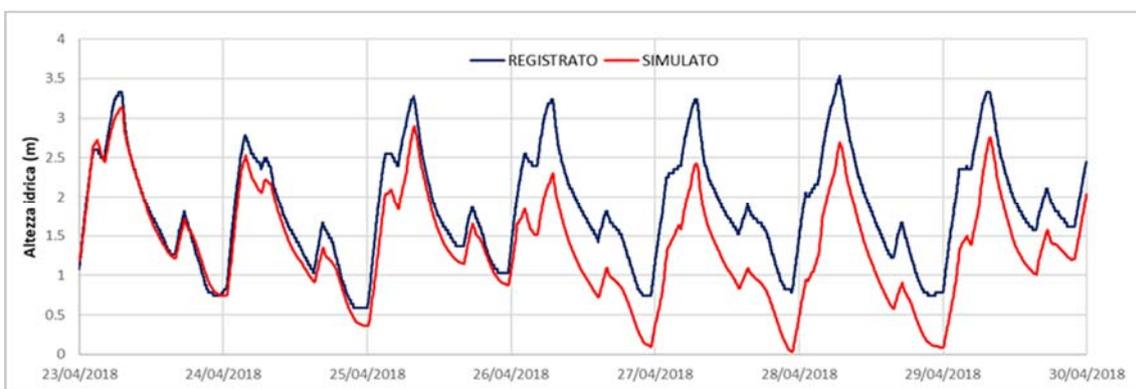
Figura 10 - Andamento dei livelli idrici del serbatoio 2 di Solana a confronto tra quello simulato dal modello (in rosso) e registrato dal telecontrollo (in blu).
