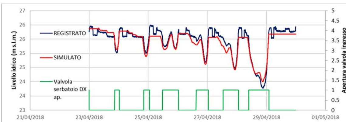
Figura 7 - Andamento dei livelli idrici del serbatoio dx di Taggi a confronto tra quello simulato dal modello (in rosso) e registrato dal telecontrollo (in blu); in verde l'andamento nel tempo della valvola che presidia gli ingressi al serbatoio (1 aperta e 0 chiusa).
