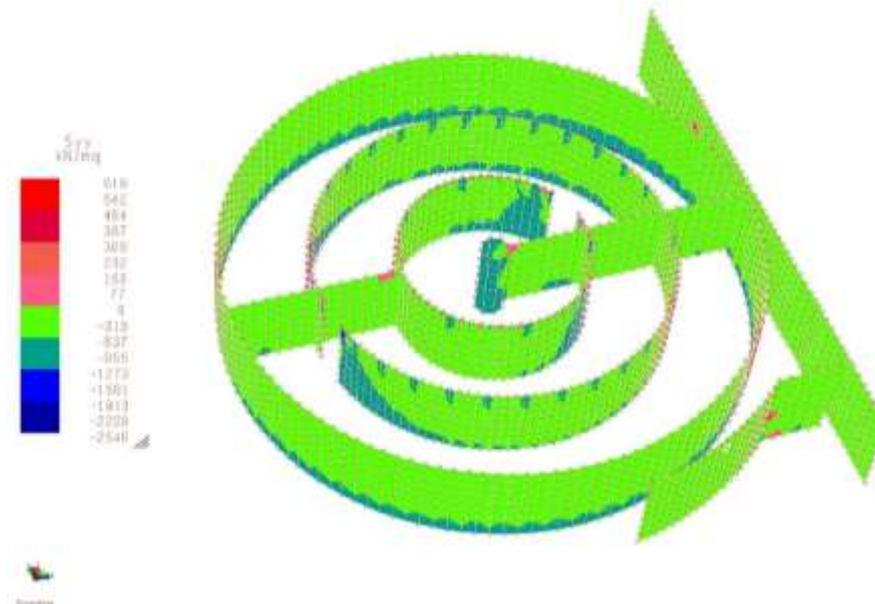
Figura 11 – Involuppo sollecitazioni tensioni membranali  $S_{yy}$  [kN/m<sup>2</sup>]
