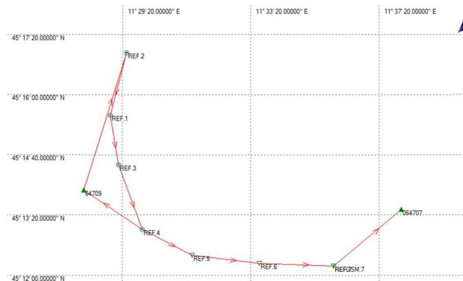
Figura 5 – Rete di poligonali di basi in statico
