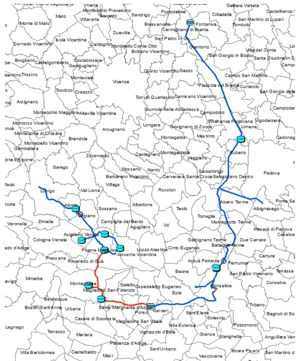
Figura 1: Schema idraulico dello scenario di progetto: in blu il sistema di adduzione esistente ed in rosso le opere di progetto
