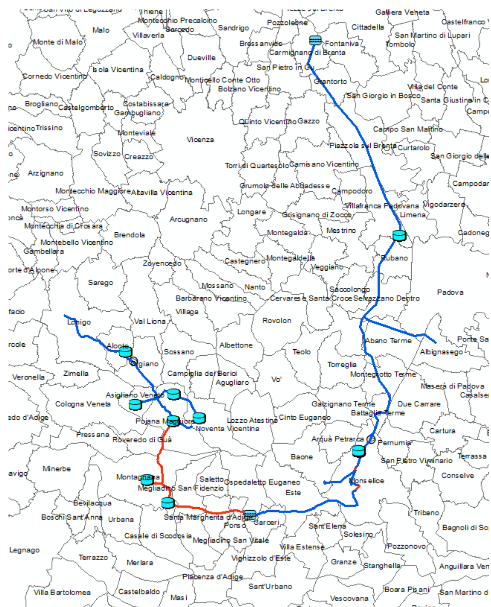
Figura 3: Schema idraulico dello scenario di progetto: in blu il sistema di adduzione esistente ed in rosso le opere di progetto
