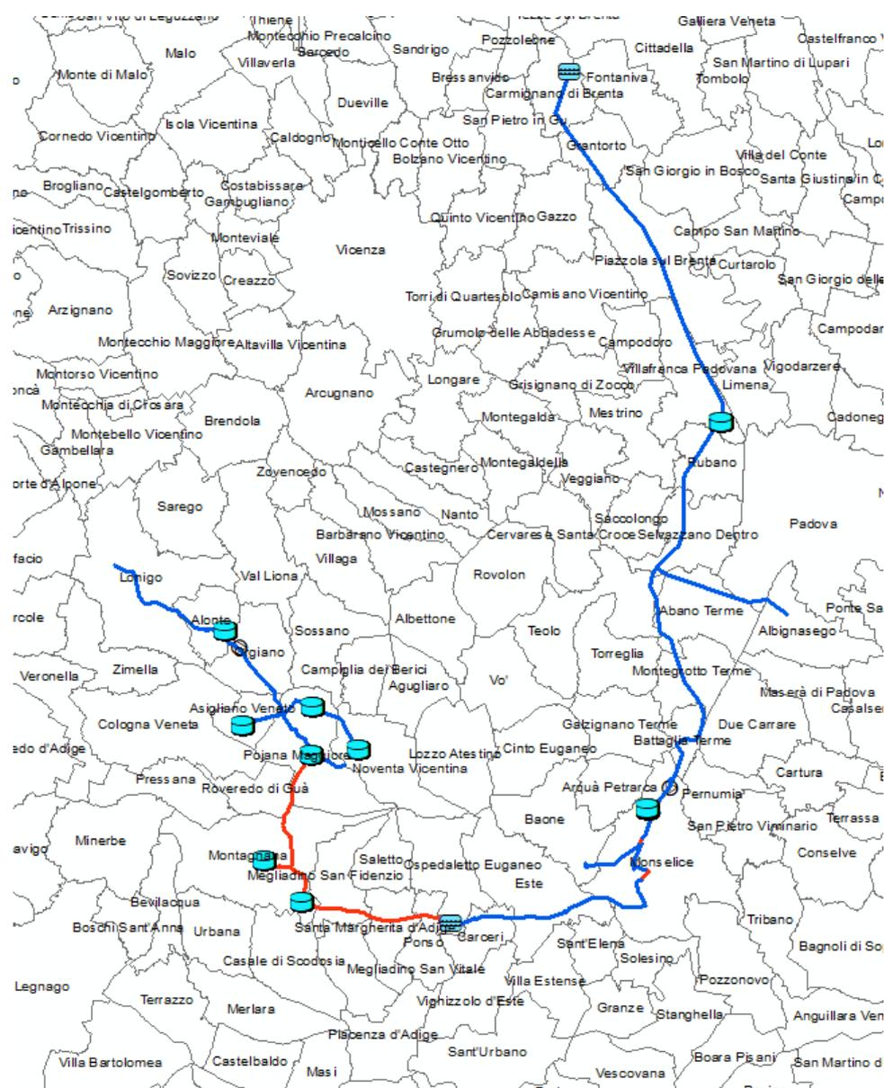
Figura 2: Schema idraulico dello scenario di progetto: in blu il sistema di adduzione esistente ed in rosso le opere di progetto
