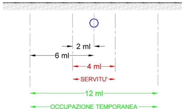
Figura 1 - Sezione tipologica posa in campagna
