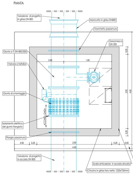
POZZETTO TIPO 2 - SCARICO SINGOLO IN CORRISPONDENZA DI UN ATTRAVERSAMENTO
