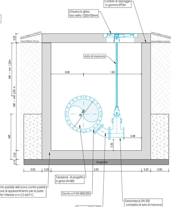
SEZIONE POZZETTO TIPO 3
