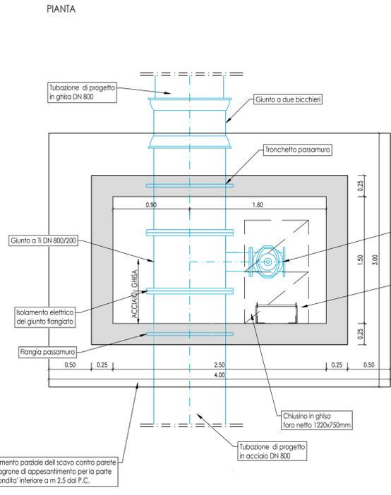
POZZETTO TIPO 3 - SFIATO SINGOLO IN CORRISPONDENZA DI UN ATTRAVERSAMENTO
