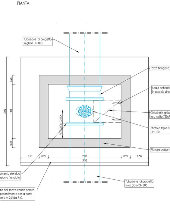
POZZETTO TIPO 4 - SCARICO SINGOLO IN LINEA
