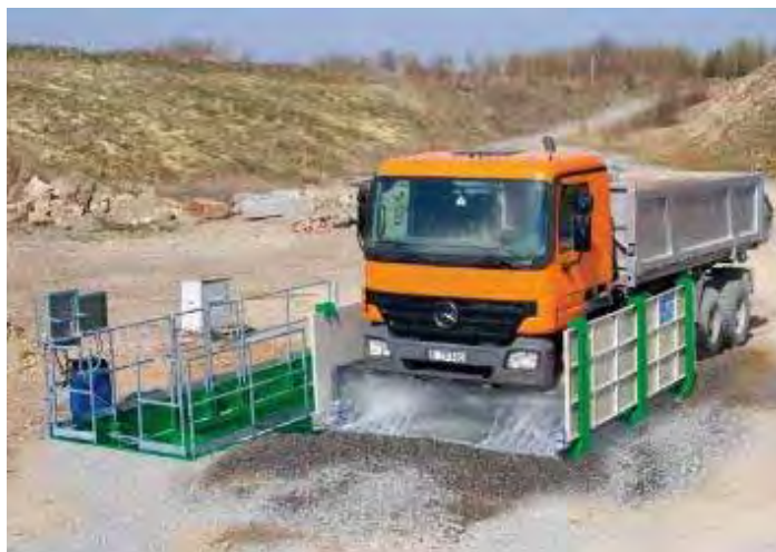
Figura 34: Impianti di lavaggio gomme automezzi
