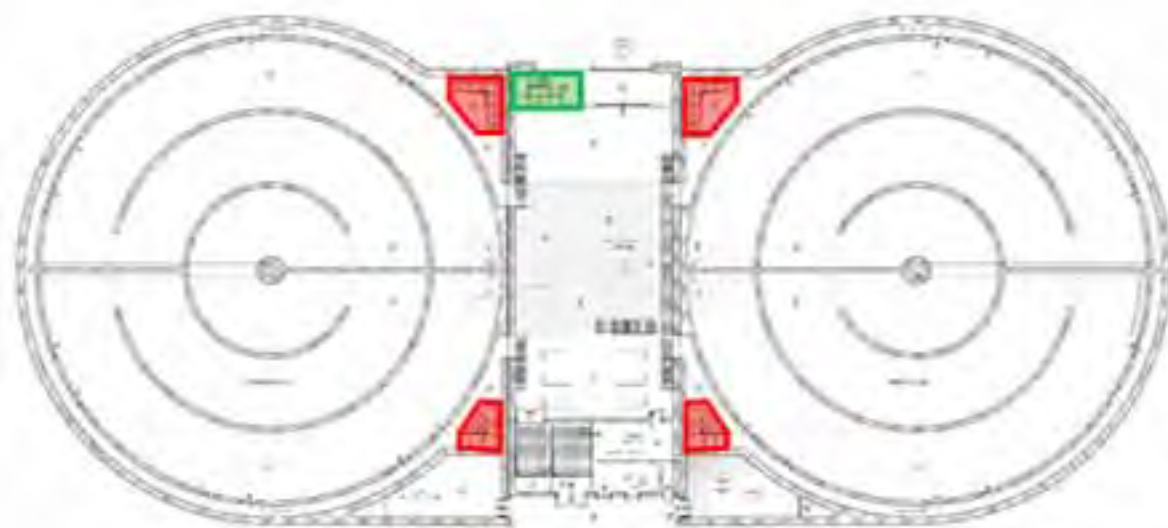
Figura 23: Ubicazione delle scale di accesso ai serbatoi (rosso) e di accesso al primo piano (verde).
