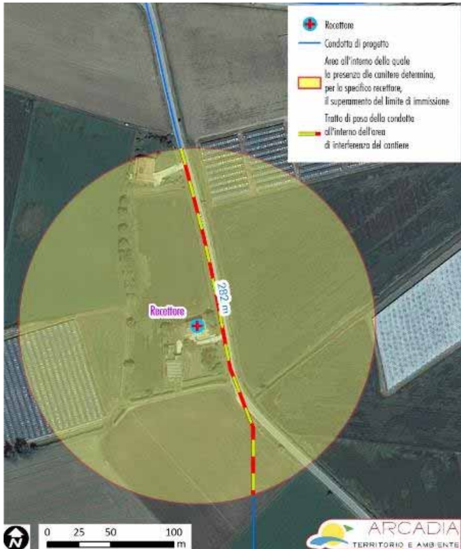
Figura 39: Area all'interno della quale il cantiere mobile determina un superamento dei livelli di immissione al recettore.
