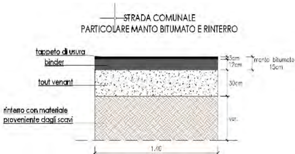
Figura 11: Sezione tipo 3 di scavo e di posa su strada comunale
