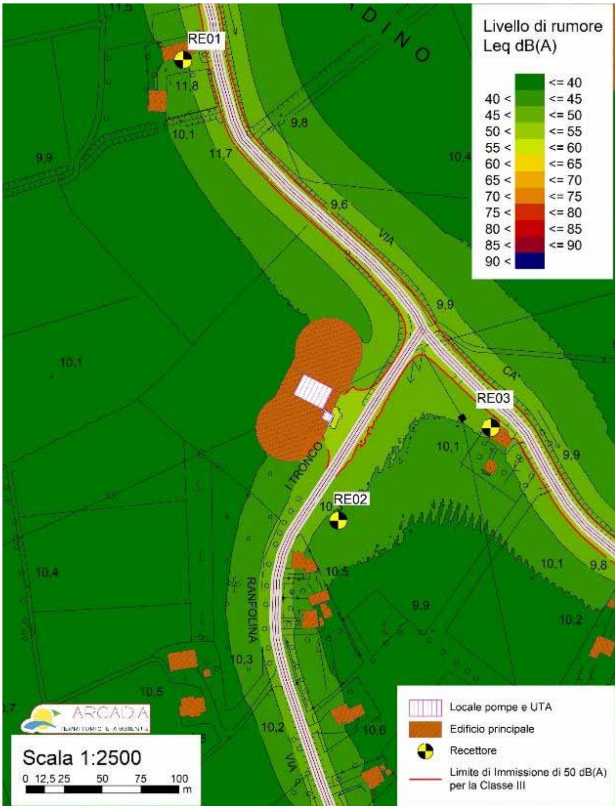
Figura 51: Situazione a 4 m dal suolo della diffusione acustica dei livelli di immissione acustica durante il tempo di riferimento diurno e notturno.
