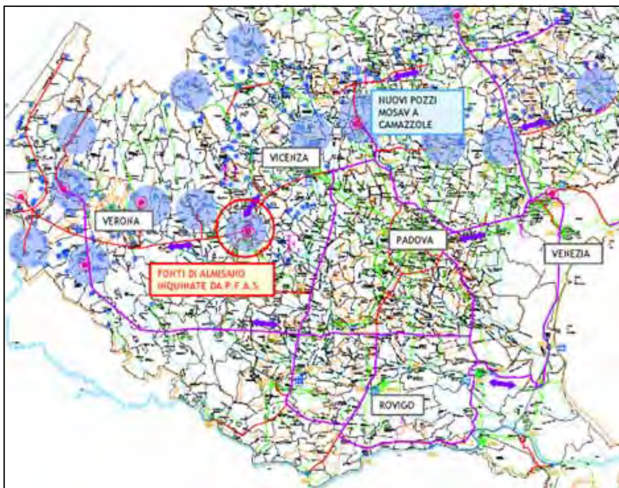
Figura 3: Corografia Modello Strutturale acquedotti del Veneto Centrale (Mo.S.A.V.) con localizzazione delle fonti di Almisano inquinate da P.F.A.S.
