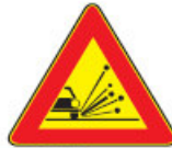
Figura II 390 Art. 31 MATERIALE INSTABILE SULLA STRADA
