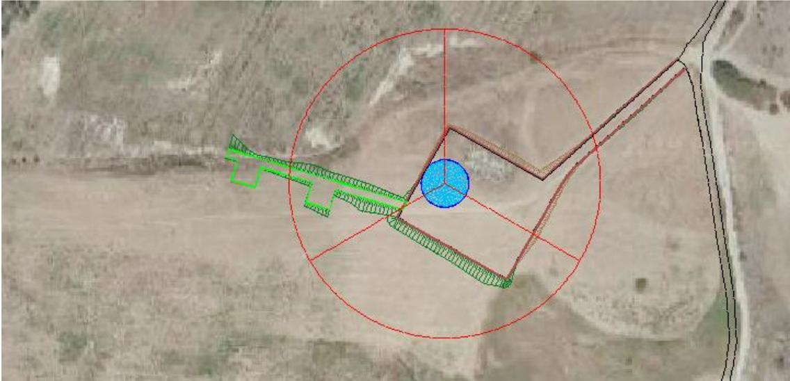
Accesso all'area di posa dell'**aerogeneratore B11**: L'accesso in tale area è previsto avvenire tramite un tratto rettilineo di nuova viabilità che sarà utilizzata anche per la posa della gru di cantiere prima del tiro in alto.
