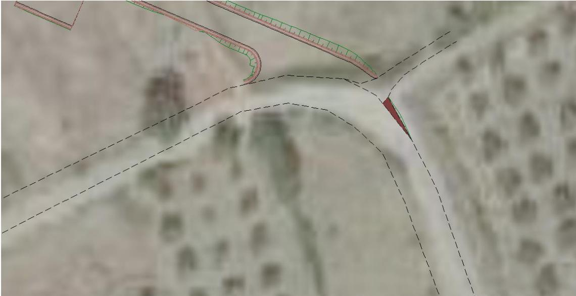
**Interventi 14 e 15:** Consistono nell'allargamento, rispettivamente interno ed esterno, di due manovre consecutive di svolta a destra per l'accesso all'area dell'aerogeneratore B06.
