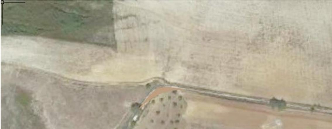
**Intervento 07:** Superata l'area di installazione dell'aerogeneratore B04, risulta necessario, per un breve tratto di circa 45 metri, allargare la piattaforma stradale onde consentire il transito verso l'area di posa dell'aerogeneratore B05.
