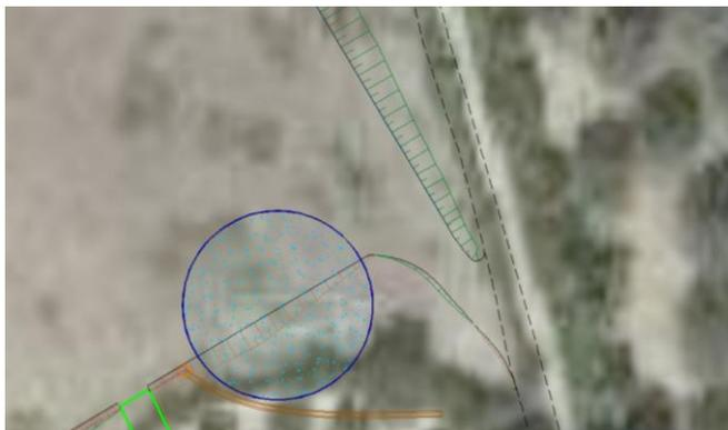
**Nuovo tracciato NT01:** Per poter arrivare all'area di posa dell'aerogeneratore B01 è prevista la realizzazione di una nuova bretella di collegamento finalizzata a minimizzare le interferenze con le alberature presenti.
