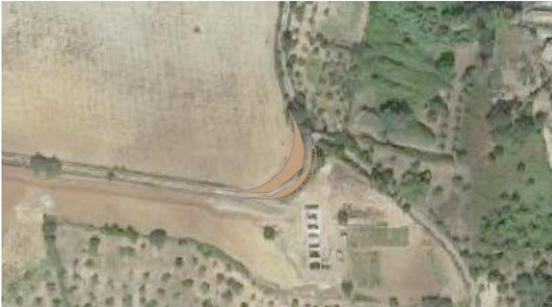
**Intervento 06:** Consiste in un allargamento interno di una curva lungo il percorso di avvicinamento agli aerogeneratori B04 e B05.
