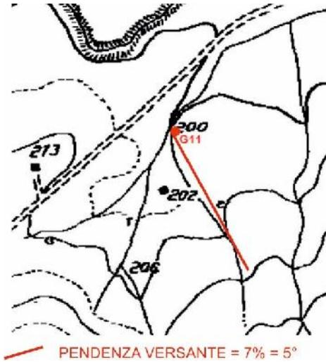
Dalla figura l'area dell'aerogeneratore G11 è posta su una zona a bassa pendenza ( $5^\circ - 7\%$ ) ad una quota di circa 200 m slm.
