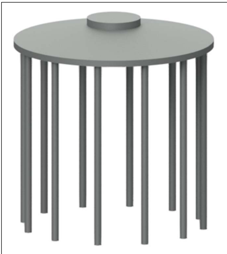
Figura 1: vista tridimensionale della fondazione dell'aerogeneratore
