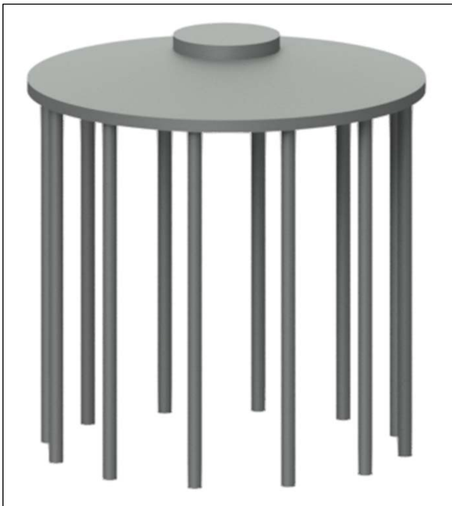
Figura 7: vista tridimensionale della fondazione dell'aerogeneratore
