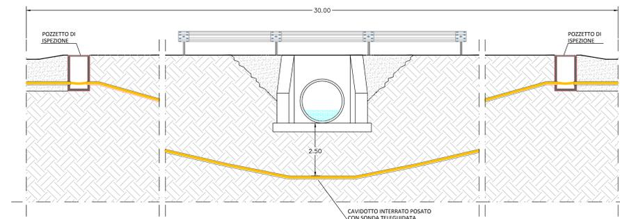
**RISOLUZIONE INTERFERENZA CAVIDOTTO – CORSO D'ACQUA MEDIANTE TRIVELLAZIONE ORIZZONTALE CONTROLLATA (INTERFERENZE N. 11-12-14-16-23)**
