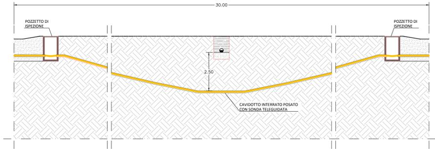
**RISOLUZIONE INTERFERENZA CAVIDOTTO – TOMBINO MEDIANTE TRIVELLAZIONE ORIZZONTALE CONTROLLATA (INTERFERENZE N. 4-6-7-8-10-17-19-20-21-22-32-38-39-40-41)**
