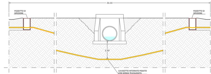
**RISOLUZIONE INTERFERENZA CAVIDOTTO – TOMBINO MEDIANTE TRIVELLAZIONE ORIZZONTALE CONTROLLATA (INTERFERENZE N. 13-18-26-27-28-29-30-31-36)**
