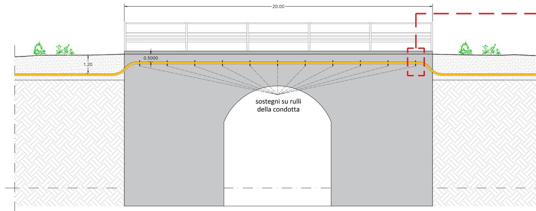
**RISOLUZIONE INTERFERENZA CAVIDOTTO – PONTE MEDIANTE STAFFAGGIO LATERALE (INTERFERENZE N. 24-25-33-34-35)**
