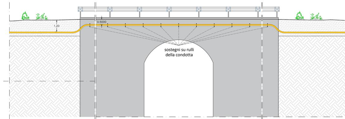
**RISOLUZIONE INTERFERENZA CAVIDOTTO – PONTE MEDIANTE STAFFAGGIO LATERALE (INTERFERENZE N. 24-25-33-34-35)**
