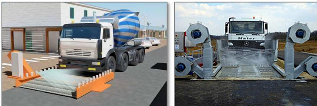
*Esempio di impianto di lavaggio gomme e impianto di lavaggio canale autobetoniere*
