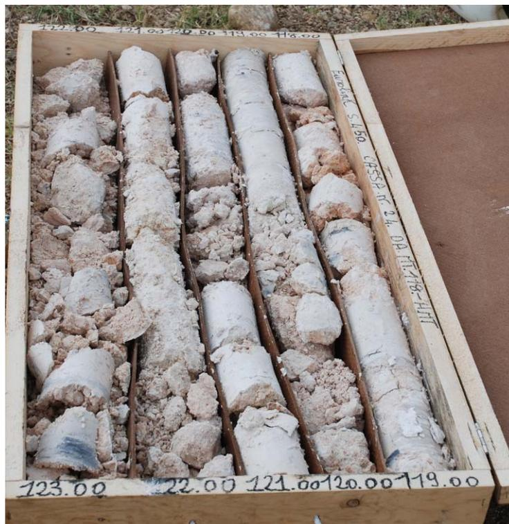
**Figura 9 - Aspetto del calcarea vacuolare, nel sondaggio S 450.**
