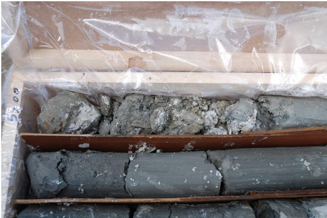
Figura 6 – Sondaggio S 452: particolare della argille gessose in cui prevale il gesso.
