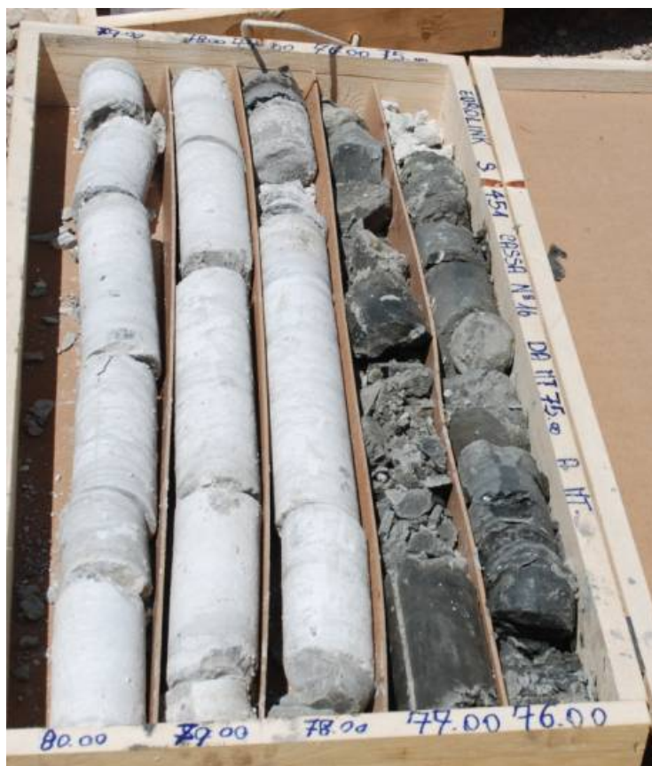
Figura 8 - Livello gessarenitico con passaggio ad argille gessose nel sondaggio S 451.
