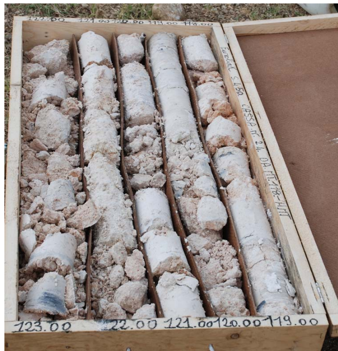
Figura 9 - Aspetto del calcare vacuolare, nel sondaggio S 450.
