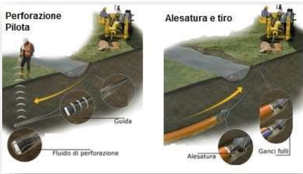
Figura 60 - tecnologia di trivellazione orizzontale controllata (TOC)
